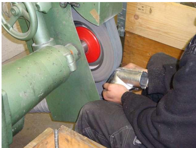
Figur 4.8. Slibning af aluminiumsemne
