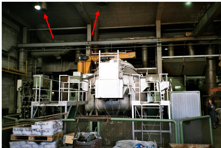
Figur 5.7. Simpel udsugning (tagventilatorer)
