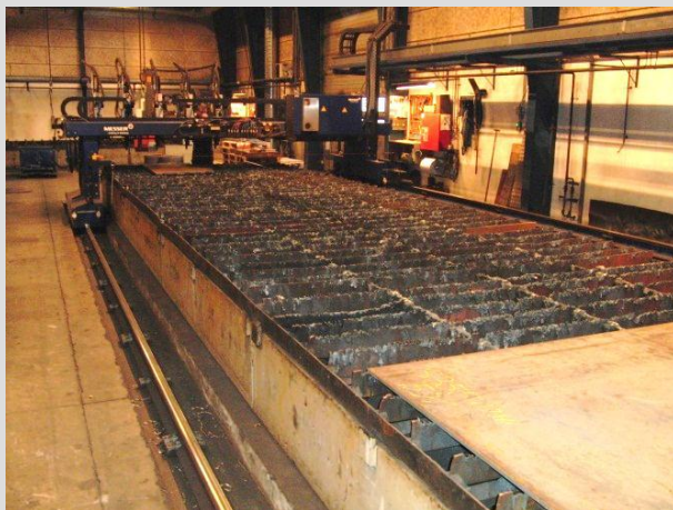
Figur 6.26. Skærebordet med følgende dimensioner B x L: 3,0 meter x 15,0 meter
