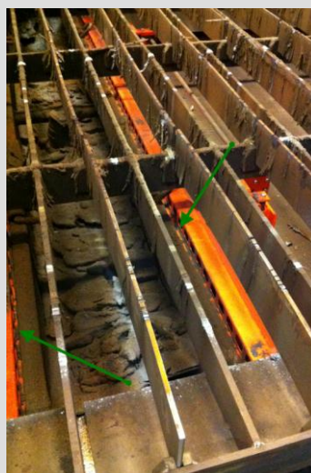
Figur 6.33. Kasse placeret nede i den mobile enhed med sugespalter markeret med grønne pile
