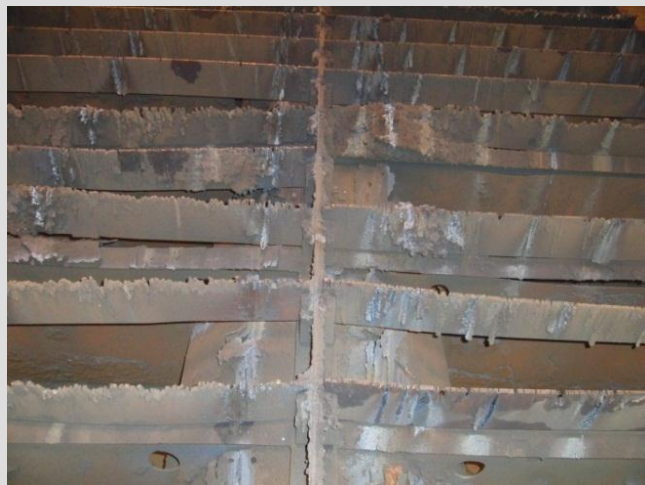
Figur 6.28. Udsnit af et gammelt skærebord. Den langsgående udsugningsdel ses under de vandrette metalbjælker
